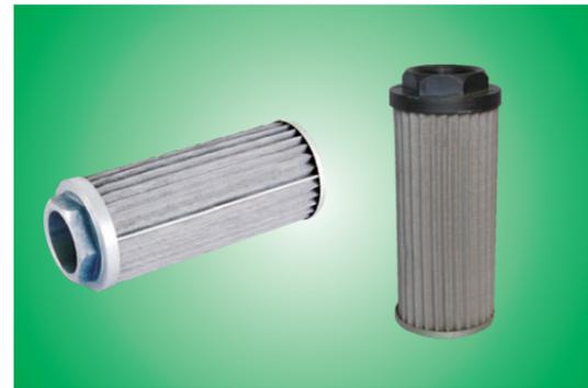
网式滤油器属于粗过滤器。一般安装在油泵的吸油口处，用于保护油泵，避免吸入较大的机械杂质。该滤油器结构简单，通油能力大，阻力小。
