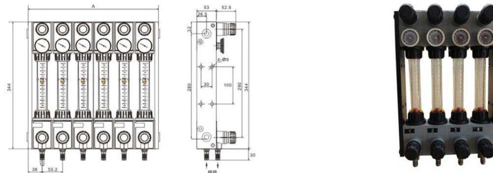
适用范围:大型注塑机;塑料加工设备的必备件,用于打开和关闭冷却回路。应用漂浮检验原理,通过水流回路中的漂浮锥的位置来表示流量。
