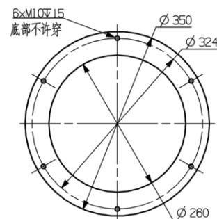
铝合金油箱盖安装法兰尺寸
